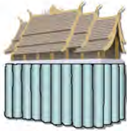
งานซ่อมแซมฐานรากที่มีการทรุดตัวของโบราณสถาน
