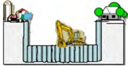
สร้างกำแพงป้องกันดินพังทลายในขณะปฏิบัติงานขุดลึก
