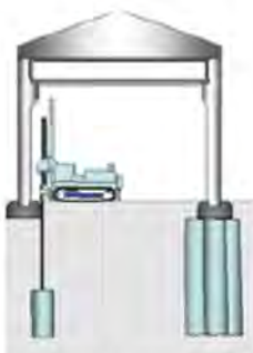
งานปรับปรุงดินใต้ฐานรากเพื่อเสริม ความแข็งแรงของอาคาร
